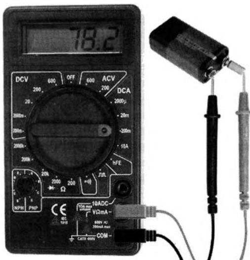
Рис. 2.68. Установка предела измерения тока
