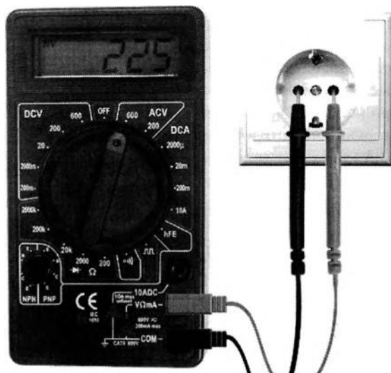
Рис. 2.65. Измерение напряжения в сети
