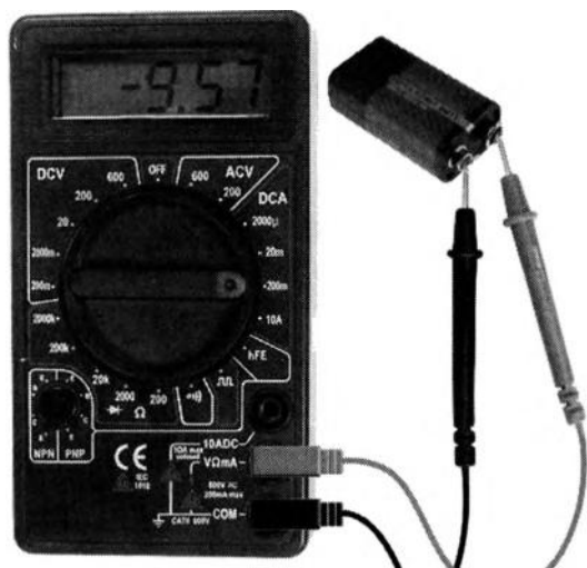
Рис. 2.63. Измерение напряжения элемента питания
