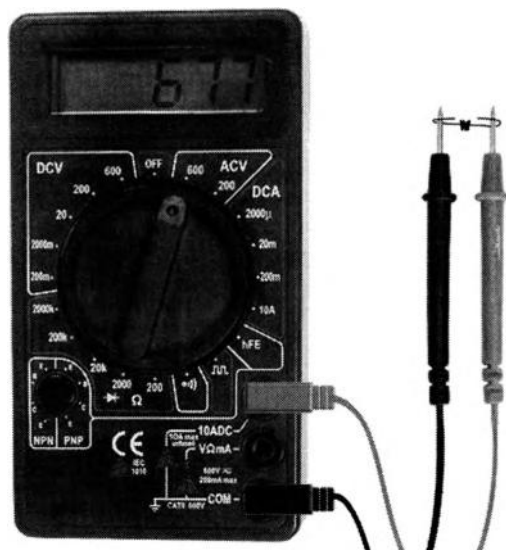
Рис. 2.66. Измерение сопротивления
