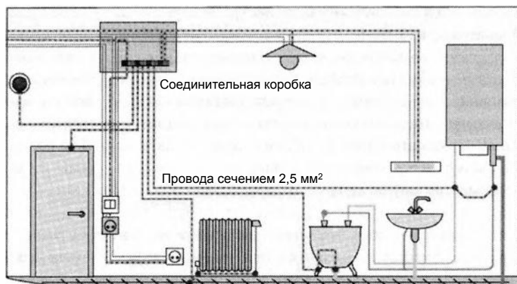
Рис. 2.40. Система уравнивания потенциалов
